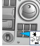
Acil Durum Frenleme Sistemi kapatma düğmesi
