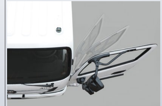
Kademeli olarak 90° açılabilen güçlendirilmiş yan kapılar
