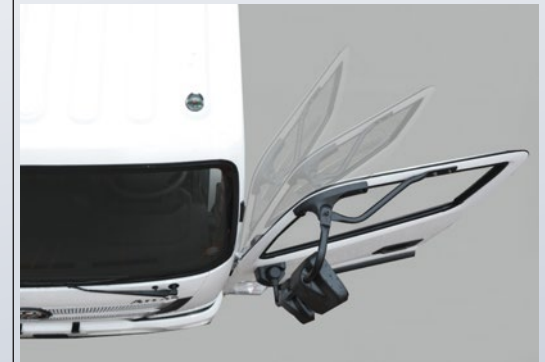
Kademeli olarak 90° açılabilen güçlendirilmiş yan kapılar
